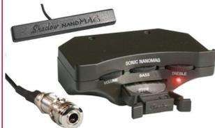
SONIC NMG NANOMAG Pick-up magnetico Nanomag per chitarra acustica. Preamplificatore da applicare all'interno della chitarra e comodamente regolabile dalla buca. Controllo di volume, alti, bassi. Alimentato con due batterie a pastiglia da 3V.
