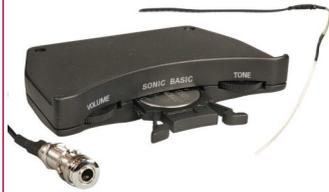
SH SONIC BASIC Pick-up piezo Nanoflex per chitarra classica ed acustica da posizionare sotto la selletta. Preamplificatore da applicare all'interno della chitarra e regolabile dalla buca. Controlli di volume e tono. Alimentato con due batterie a pastiglia da 3V.
