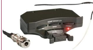
SH SONIC NFX NANOFLEX Pick-up piezo Nanoflex per chitarra classica ed acustica da posizionare sotto la selletta con preamplificatore da applicare all'interno della chitarra. Controllo di volume, alti, bassi. Alimentato con due batterie a pastiglia da 3V.
