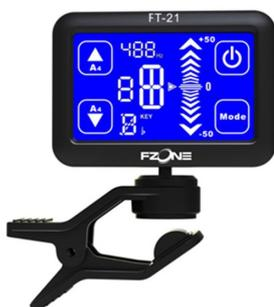
FT-21 Accordatore digitale cromatico a clip con comandi a touchscreen, intonazione del LA regolabile da 430 a 450 Hz, sensore di vibrazione incorporato. Modalità di funzionamento: cromatico/chitarra/basso elettrico/violino/ukulele. Colore nero.
