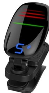
FT-16 Accordatore digitale cromatico a clip, intonazione del LA regolabile da 436 a 440 Hz, sensore di vibrazione incorporato. Display multicolore. Modalità : cromatico. Colore nero.
