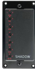
SH EQ5 "Il Camaleonte" Pick-up humbucker attivo. Equalizzatore a 5 bande: 100 Hz, 300 Hz, 1 KHz, 5 KHz, 10 KHz. Le bande sono regolabili singolarmente mediante l'apposito cacciavite. Livello input e master gain. Predisposto per l'uso attivo e passivo.
