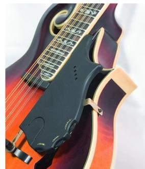
SH 927 NMG4 Sistema professionale di amplificazione per mandolino "bluegrass". Quattro pick-up Nanomag in un unico alloggiamento. Preamp nel battipenna con regolazione del volume separata per ogni coppia di corde. Controlli di volume, alti e bassi.
