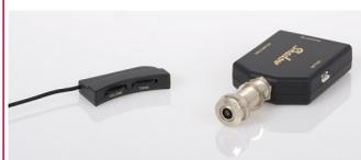
SH M-Sonic C NFX VT Pick-up Nanoflex per chitarra classica da posizionare sotto la selletta. Presa jack con preamplificatore da sostituire all'attacco tracolla e unità di controllo con regolazione di tono e volume da applicare nella buca.
