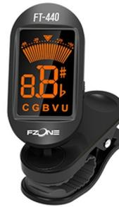
FT-440 Accordatore digitale cromatico a clip, intonazione del LA 440 Hz, sensore di vibrazione incorporato. Display con cambio di colore. Modalità di funzionamento: cromatico/chitarra/basso elettrico/violino/ukulele. Colore nero.
