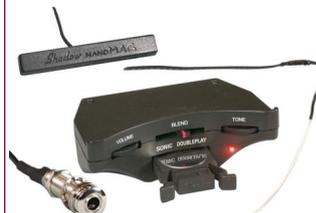
SH Sonic DP Dualplay Sistema a due pick-up per chitarra acustica. Pick-up piezo Nanoflex e pick-up magnetico Nanomag. Preamplificatore da applicare all'interno della chitarra. Controllo di volume, tono e blending dei pick-up. Due batterie a pastiglia da 3V.
