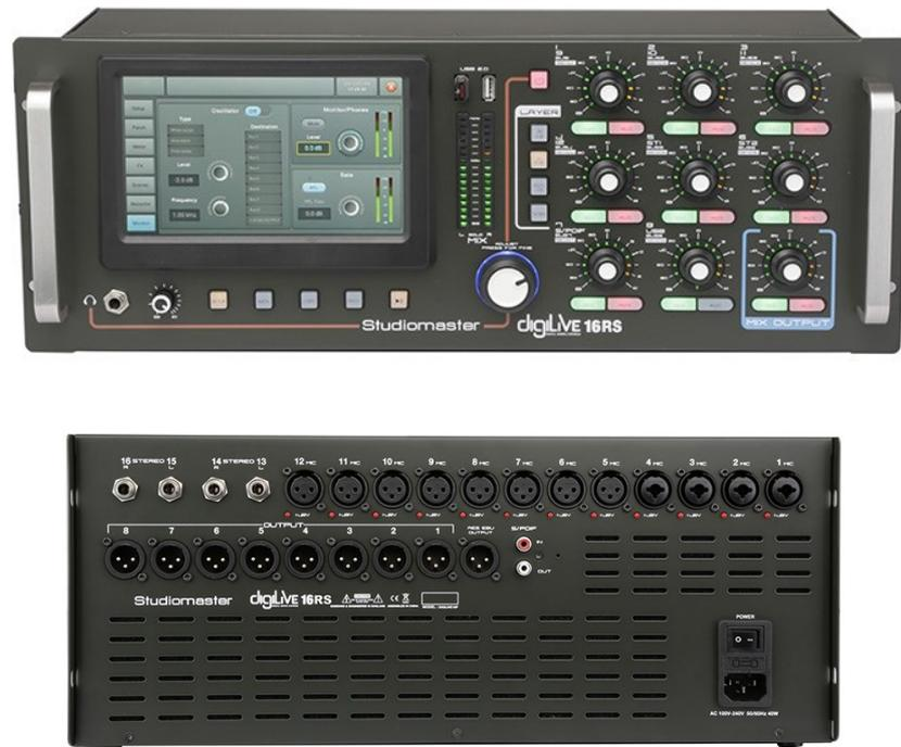
Il mixer digitale a rack digiLIVE 16RS è dotato di 16 ingressi, 9 potenziometri digitali rotativi, un ampio touch screen multifunzione, due porte USB, e la possibilità di essere completamente controllato a distanza da iPad (iOS 7 o successivi) tramite il modulo Wi-Fi in dotazione e una app disponibile su iTunes.
