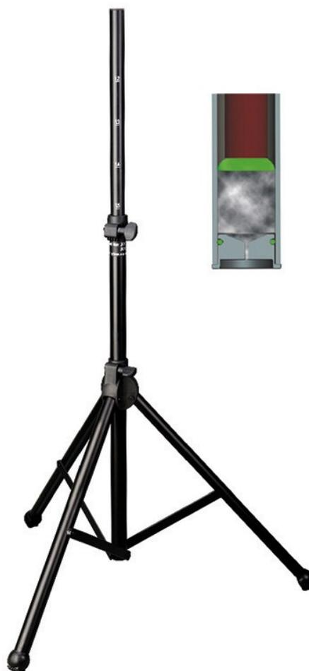
Supporto per diffusore in lega di alluminio, altezza regolabile da 1.100 a 1.800mm, capacità di carico 50 kg, diametro tubolare 35 mm, dimensione confezione 125x135x1125mm. Il meccanismo a cuscino d'aria garantisce una discesa lenta e morbida dei diffusori.
