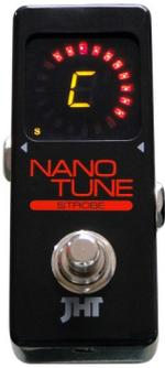
Nano Tune Strobe. Accordatore a pedale, modalità True Strobe o Meter. Flat tuning. A0/C8. Precisione +/- 0,02 cents. LA (A4) da 420 a 459,9 Hz +/- 0,1 Hz. Ingresso ed uscita jack mono 1/4". True bypass. Necessita di alim. esterna 9V (DC, 100mA) Peso g. 145.
