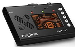
FZone FMT-331 Metronomo/accordatore digitale cromatico, display LCD e LED, LA regolabile da 410 a 490 Hz. Sensore di vibrazione e microfono. Battute da 0 a 9, tempo da 30 a 280 bpm, 7 ritmi. Tone generator. Accordatore: cromatico/chitarra/basso elettrico/violino/ukulele.
